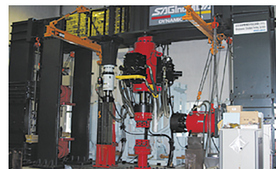
超高速衝撃構造性能評価システム (最大荷重:1200kN, 荷重速度:1.2m/s)
