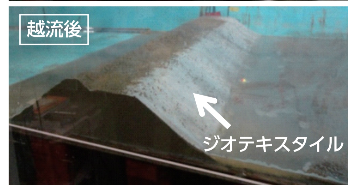
盛土の防潮に関する越流実験
