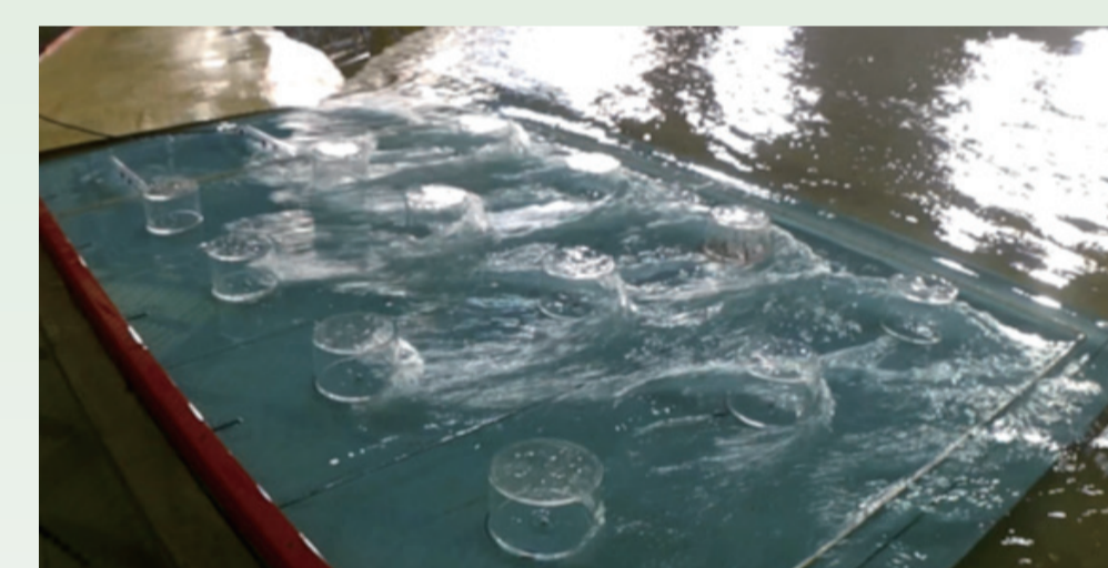
石油タンクに作用する津波流体力の実験
