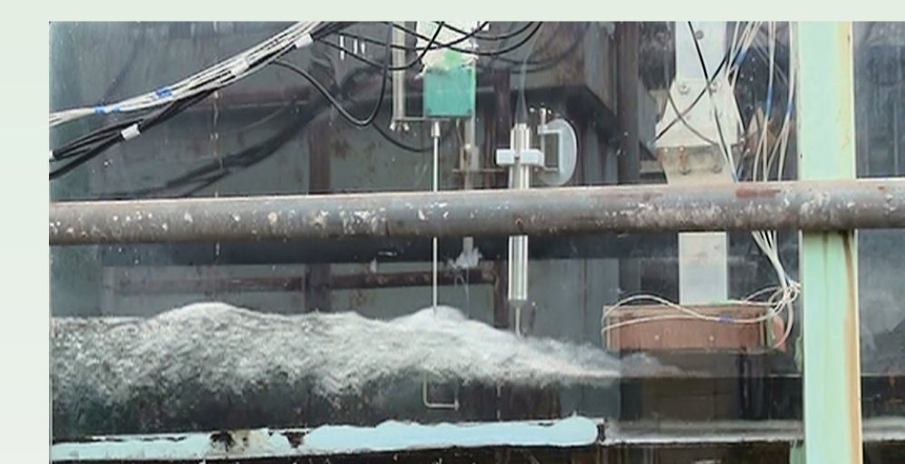
橋梁に作用する津波流体力の実験
