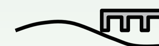
橋梁模型に作用する鉛直方向の津波流体力(非砕波, 波高8.3cm, 桁下高さ5.0cm)
